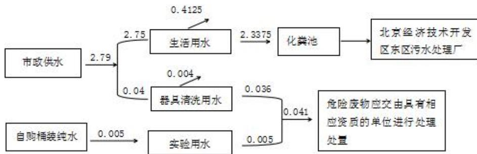
图 2-1 项目运营期水量平衡图单位 ( $\text{m}^3/\text{d}$ )
